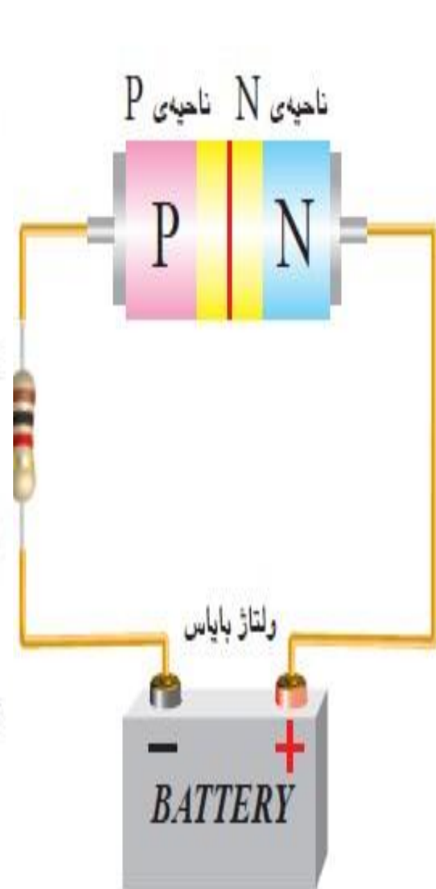
شکل ۵-۳ پیوند PN در بایاس مخالف
