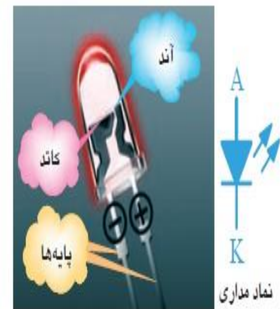
شکل ۵۵-۳ نماد مداری و ساختمان داخلی LED
