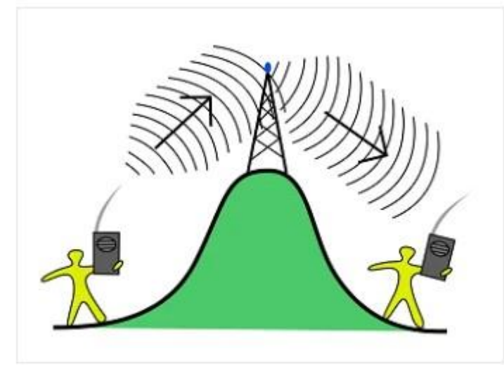
شکل (16): قرارگیری آنتن واسط بین فرستنده و گیرنده اصلی (انتشار غیر مستقیم)
